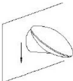
Premere il contenitore verso il basso . Verificare il fissaggio del contenitore, se non risultasse sufficiente, stringere le viti
