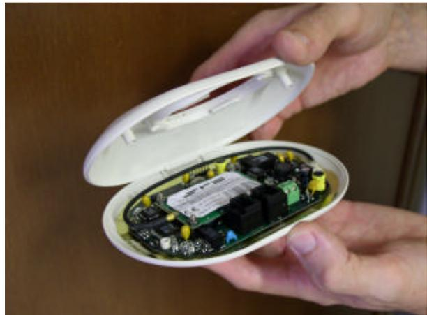
Per rimuovere la base dal contenitore ruotare quest'ultima in senso orario rispetto al contenitore. Attenzione! Non serve molta forza per lo sganciamento quindi non forzare; se si incontra un' eccessiva resistenza verificare il senso di rotazione.
