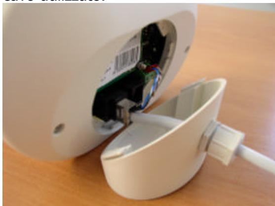
È sufficiente a questo punto eseguire le connessioni come indicato nei punti precedenti ed installare a parete DigiClock GPS; per ottenere un grado di protezione maggiore utilizzare un sigillante siliconico nei punti di unione delle 3 parti del contenitore.
