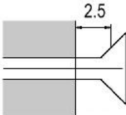
Fissare alla parete due viti (diam. max gambo 3mm, diam. Max. testa 6mm)
