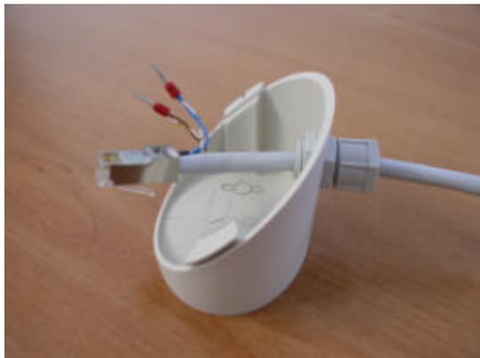
La base di fissaggio è stata quindi lavorata per permettere l'inserimento di un pressacavo adeguato alla sezione del cavo utilizzato.
